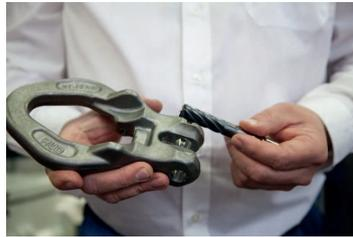
**Der Rohling eines sogenannten Mulden-einhängeglieds wird in einer Aufspannung bearbeitet und die Nut trochoidal ausgeräumt. Die CircularLine Fräsern CCR Uni von WNT ermöglichen einen sicheren Prozess bei hohen Standzeiten.**
